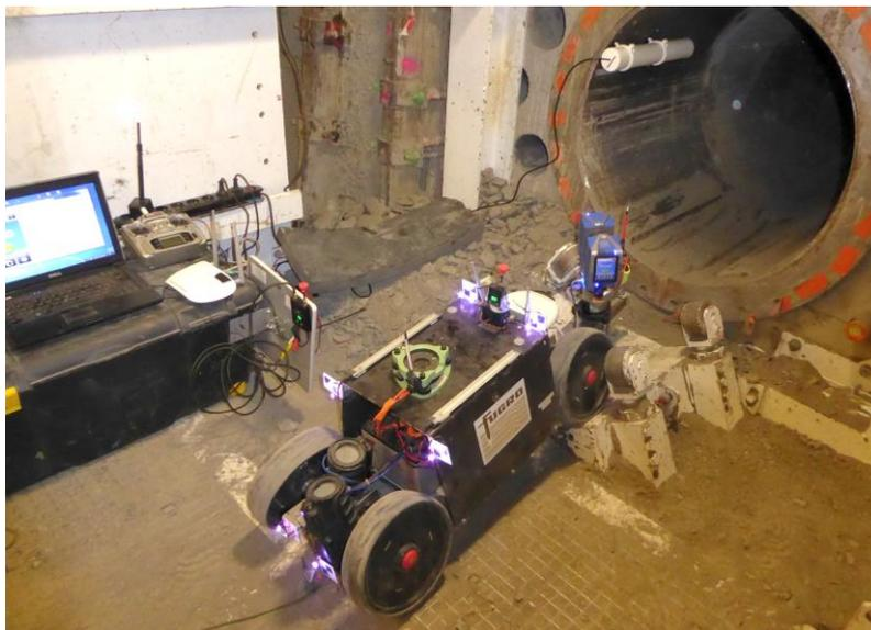
Figure 9: Le système téléguidé de numérisation laser 3D d'alvéole, développé par Fugro France
