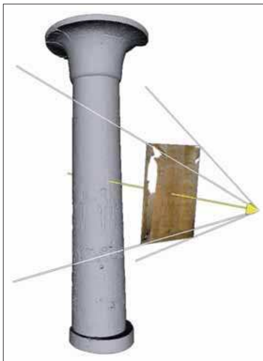
FIG. 4. – Principe de projection d'une image photogrammétrique sur le modèle 3D (B. Chazaly).
