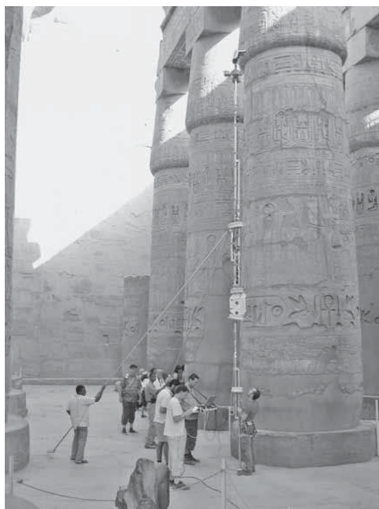
FIG. 2. – La « perche » mise au point par l'équipe de l'ENSG. Les quatre appareils photographiques calibrés qui y sont fixés, sont déclenchés simultanément à partir d'un ordinateur (E. Laroze).
