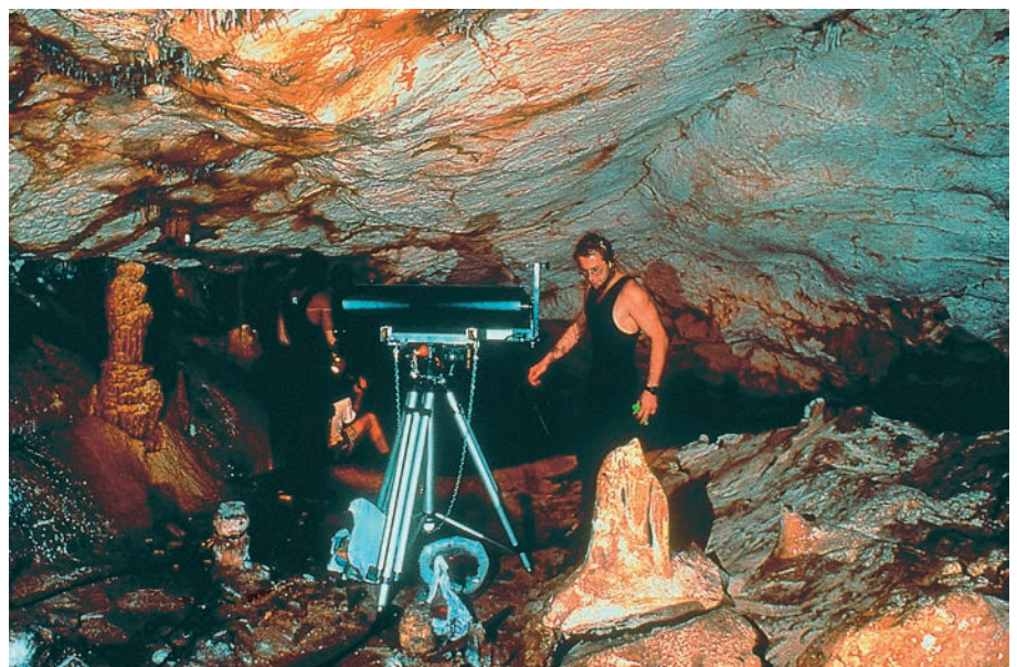
Photo 5 : Le scanner Soisic en station dans la salle 2. Cliché Ministère de la Culture / EdF. Soisic scanner on station in chamber 2.
