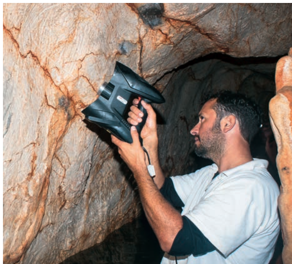
Photo 11 : Acquisition inframillimétrique du panneau des chevaux à l'aide d'un scanner Noomeo Optimum. Cliché Luc Vanrell / Immadras, SRA PACA. Sub-millimeter capture of the panel with the horses using a Noomeo Optimum scanner.
