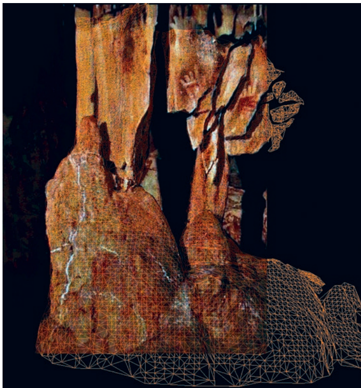
Photo 6 : Maillage du nuage de points de la draperie du puits avec superposition de la photographie en transparence (document EdF). Points cloud of the drapery of the pitch with the superimposed photo visible by transparency.
