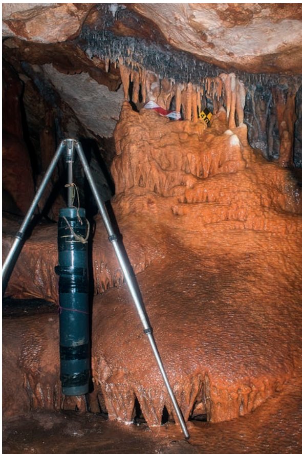
Photo 8: Balise électromagnétique de la société Valade Minage en station dans la salle 2, à proximité du passage vers la salle 1. Cliché Luc Vanrell / Immadras, SRA PACA. Electromagnetic beacon of Valade Mining society on station in chamber 2, near the "porthole", passage to chamber 1.
