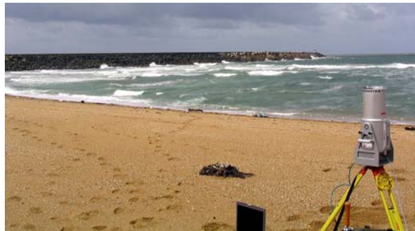
Fig. 2 : Le scanner Riegl LMS 420i numérisant la digue nord
