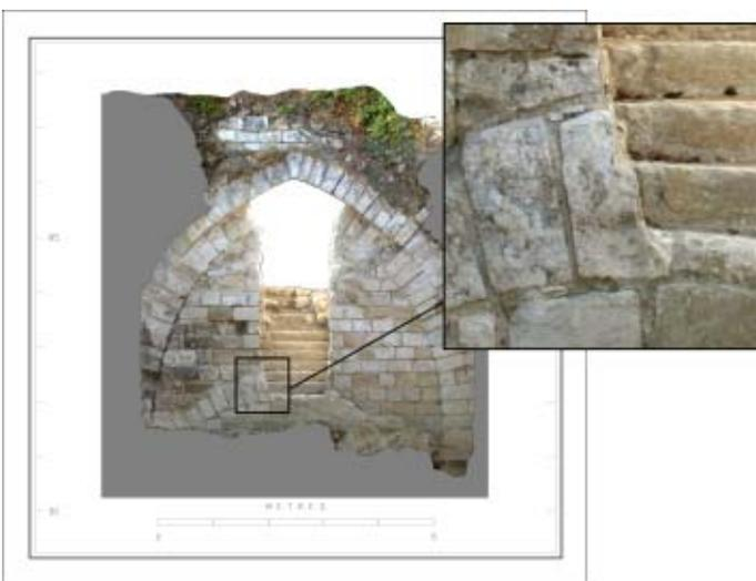
Numérisation 3D et couverture photographique des élévations du site en 48h. Restitution du pierre à pierre des élévations sous forme de modèles maillés 3D, de courbes de niveaux et d'orthophotographies couleur au 1/20.
