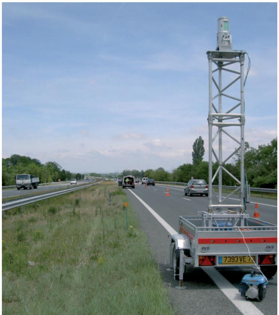
Figure 1 : levé au scanner 3D sur 15 km des quatre voies de l'autoroute A42, sous circulation et en balisage léger (extension des voies en terre plein central).
