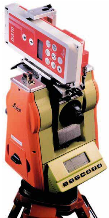
Figure 4. Le Leica DISTO, monté sur la lunette d'un tachéomètre électronique, permet les premières mesures de distance sans prisme.
