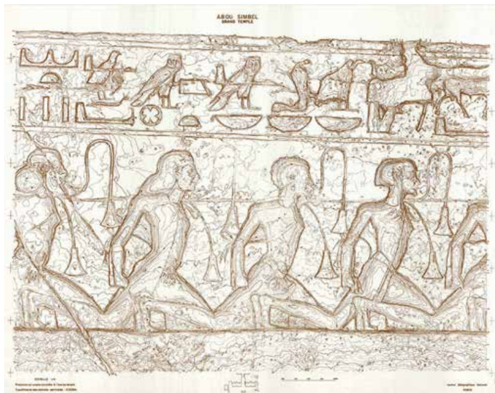
Figure 1. Restitution photogrammétrique à l'échelle 1/4 d'un fragment du grand temple d'Abou Simbel.
