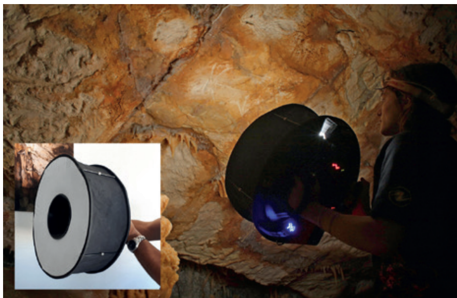
Figure 14. Le système de prise de vue photogrammétrique et son diffuseur annulaire mis en œuvre dans la grotte Cosquer.
