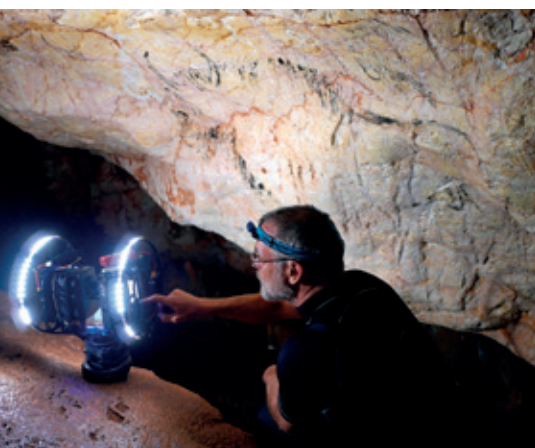
Figure 11. Le scanner 3D et son système d'éclairage coaxial pendant la numérisation de la grotte Cosquer.
