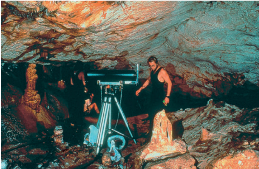
Figure 8. Le capteur Soisic, développé par la société Mensi en partenariat avec les chercheurs d'EDF.
