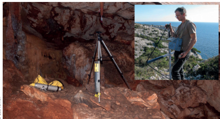
Figure 14. Balise électromagnétique utilisée pour le géoréférencement de la grotte, repérée depuis le toit du massif karstique.
