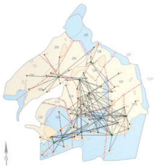
Figure 10. Le réseau de repères topographiques posés dans la grotte.
