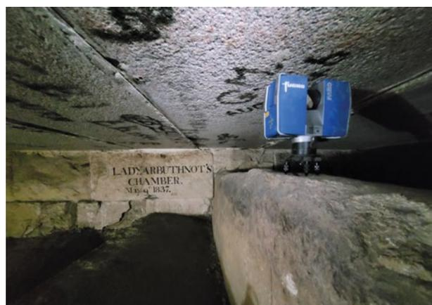
Figures 2 et 3. Lasergrammétrie dans la galerie verticale (à gauche) et en chambre de décharge (à droite).
